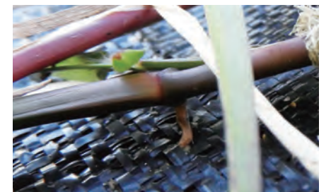
センチビードグラスの節根がシートを貫通
