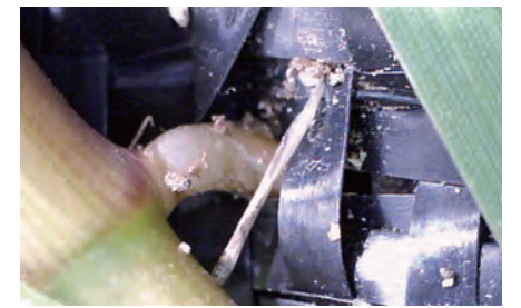
センチビードグラスの節根がシートを貫通
