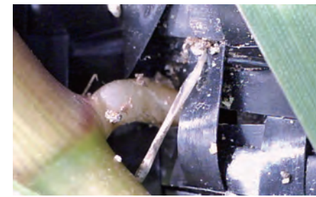
センチビードグラスの節根がシートを貫通
