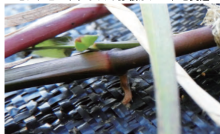
センチピードグラスの節根がシートを貫通
