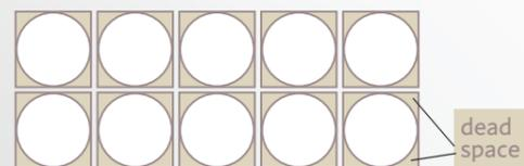
20フィートコンテナに10袋積むと、丸型コンテナ10.6kℓに対して角型コンテナ13.5kℓと、約2.5袋分増えます!!
